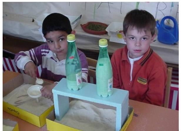
Pour comparer les durées d'écoulement, il est nécessaire que les élèves comprennent qu'il faut basculer les bouteilles en même temps. C'est pourquoi chaque binôme possède une sorte de portique percé de deux trous dans lesquels peuvent pénétrer les goulots des bouteilles.
